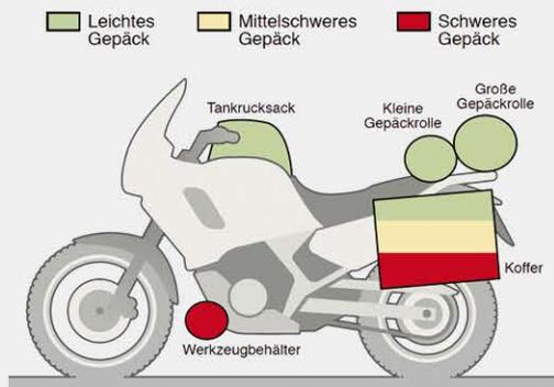
Das korrekt beladene Motorrad verhält sich in seiner Fahrdynamik ähnlich wie das Unbeladene. Achte darauf, dass die schweren Gepäckstücke möglichst nahe am Schwerpunkt des Motorrades und nahe ab Boden verstaut sind. Andernfalls kann sich das Fahrverhalten deines Motorrades negativ verändern.
